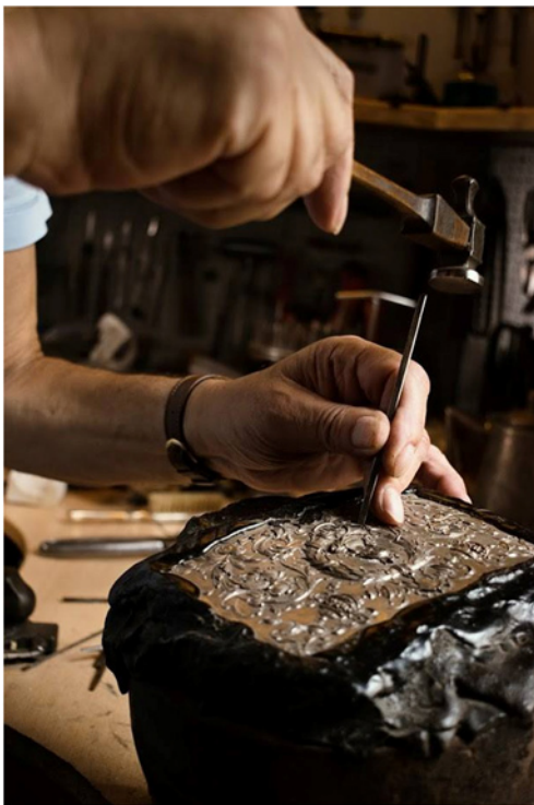
Cizellálás. A cizellálás művelete két fő részből áll: domborításból és a domborított, (vagy öntött felületek) részletdús kidolgozásából. Eszközei: 1. cizellőr kalapács, 2. Különféle végű poncolók sokasága. 3. szurokgolyó. A 10-12 cm hosszú, nemesacélból készült poncolók sűrű ütögetésével érjük el a lemez kívánt mélységét, vagy a mintázat finomítását. (fotó: Kiss Zsuzsanna)
