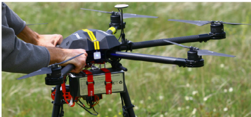
3. ábra: A drónokban használt Li-Po akkumulátor (szürke színnel, piros hevederrel átkötve)
